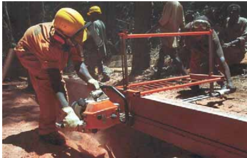
Mobiele zaag die veel in dorpsbossen wordt gebruikt (foto: Pierre-Paul Fiété, uit 'Couper au Cameroun', J. Mientens, 2001)
