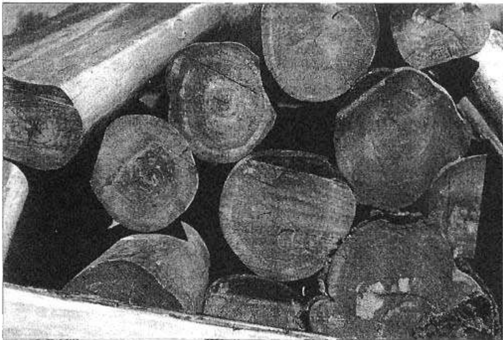
Fig. 6 Troncos de olmo libres de corteza luego de inmersión en agua (Dekker en Zoon BV, Monnikendam)
