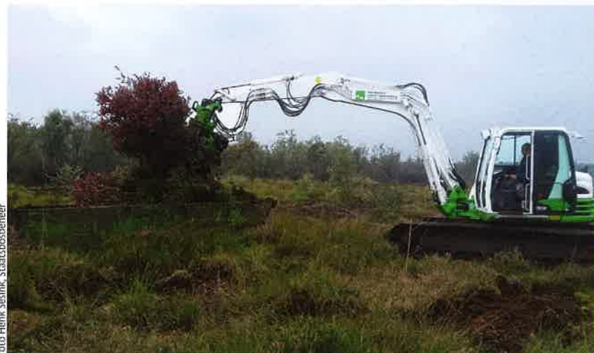
Afbeelding 2. Uittrekken van de trosbosbes met een rupskraan met sorteerknijper.
