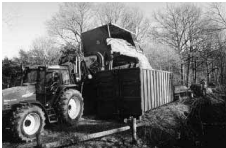
De chips worden met een hoogkiep bak overgeladen in een container op de berijdbare bosweg. Foto: SBH.
