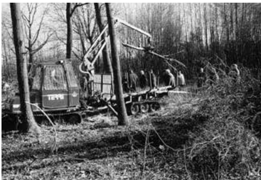
Voor het uitslepen werd onder andere een mini-forwarder op rupsbanden gebruikt, die speciaal voor zeer natte terreinomstandigheden is ontwikkeld. Foto: SBH.
