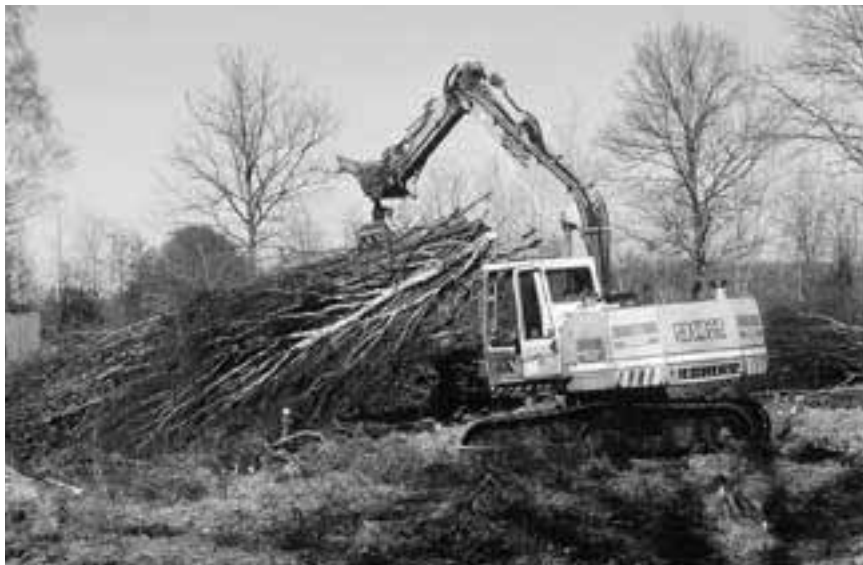
Een rupskraan werd ingezet om het materiaal te concentreren en over te draaien naar berijdbare, drogere plekken in het terrein. Foto: SBH.
