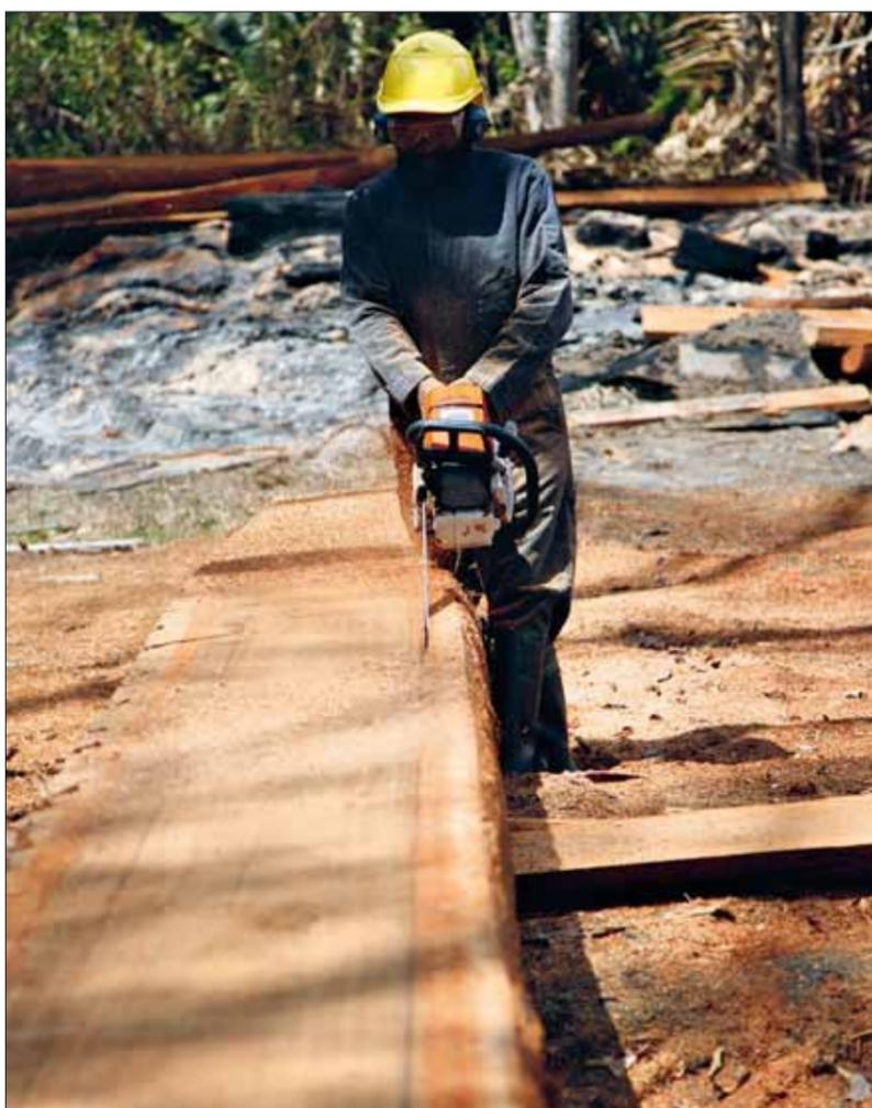
Ein Bongossi-Vierkantpfahl wird mit der Motorsäge zugeschnitten
