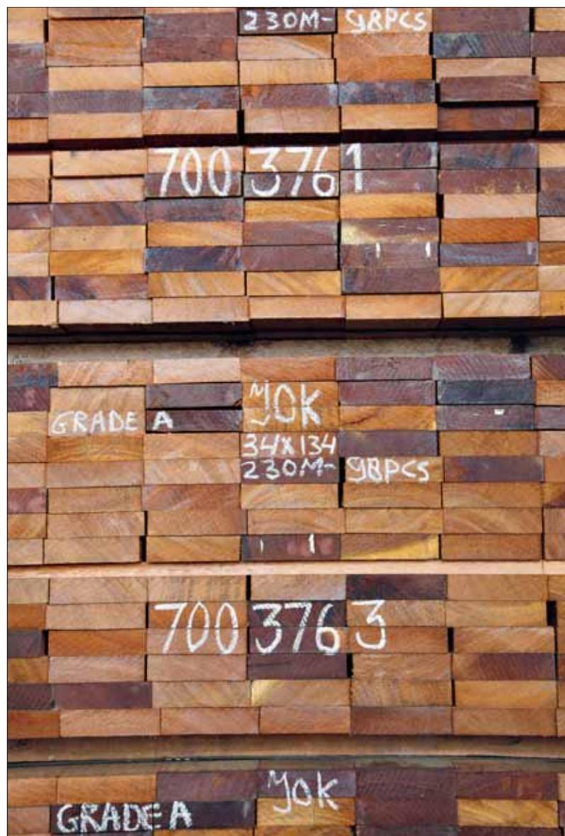
FSC-zertifiziertes Fava Amargosa, geeignet für Erd- und Wasserbau (z. B. Fußgängerstege, Spundwände und Uferschutzanlagen) Foto: M. van Benthem (4)
